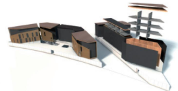
Morphologie | • bardage métal • ossature bois • plancher béton
