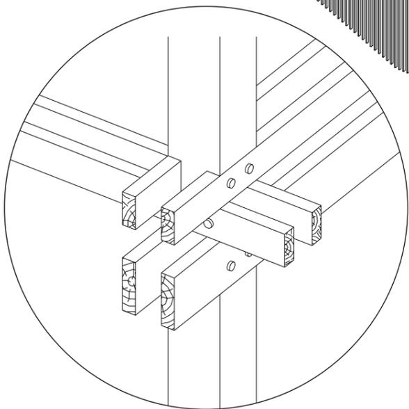
Assemblage de poutres à double moisant
