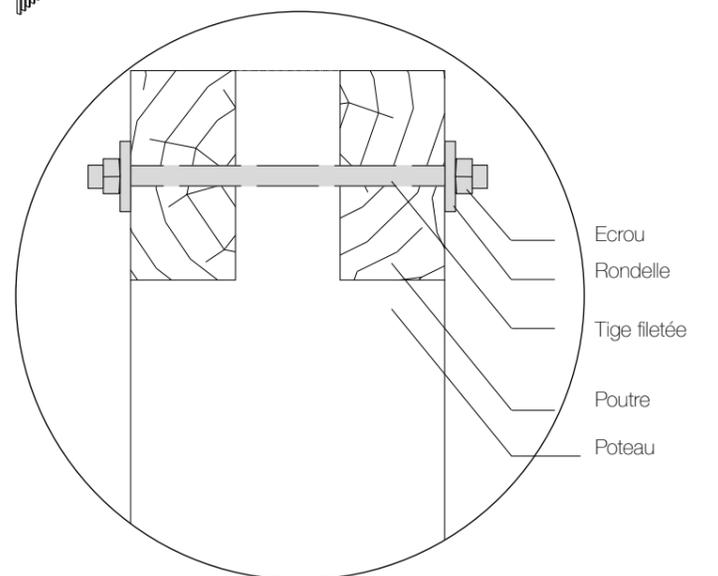
Coupe de la fixation des poutres au poteau
